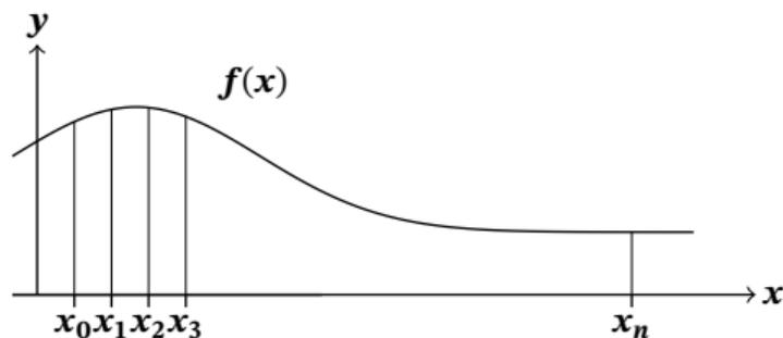
区間を  $x_1, x_2, x_3, \dots$ , と区切り,  $f(x_n)$  の値を求め, プロットしていく.
